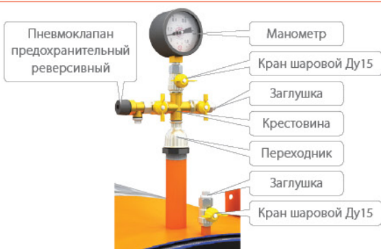
A. Технологическое оборудование системы контроля герметичности межстенного пространства с газовым наполнением
